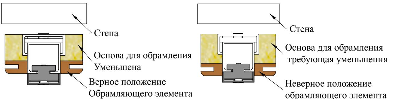
17. Установить наличники. В вертикальных стойках выполнены пазы по боковым стенкам для установки телескопического наличника. В первую очередь установить вертикальные стойки наличника затем горизонтальные. Для обеспечения надежного прилегания наличника к стене необходимо его приклеивание при помощи монтажной пены в нескольких местах и обязательной фиксации наличника молярным скотчем до полного высыхания пены.
